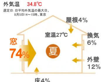
【熱の流入出比率】解析No.00033●使用ソフト:AE-Sim/Heat(建築の温熱環境シミュレーションプログラム)/(株)建築環境ソリューションズ●気象データ:「拡張メテオ気象データ」2010年版標準年/(一社)日本建築学会 ●住宅モデル:2階建て/延床面積120.08㎡/開口部面積32.2㎡(4~8地域)「平成25年省エネルギー基準に準拠した算定・判断の方法及び解説II住宅」標準住戸のプラン●躯体:平成28年省エネルギー基準レベル相当●窓種:アルミサッシ(複層ガラス(A8未滿))
